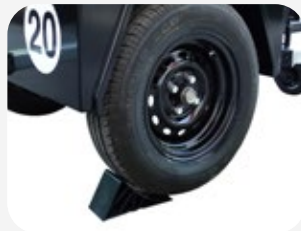
Ruedas con neumático P175/80 R13 y calzo de seguridad para ruedas.
