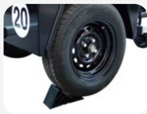
Roues avec pneus P175/80 R13 et calage de sécurité pour roue.
