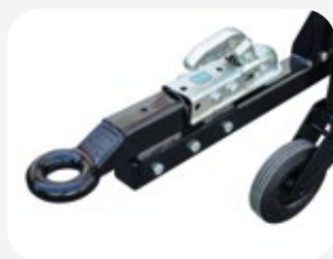
Double connexion pour remorquage: boule et anneau.
